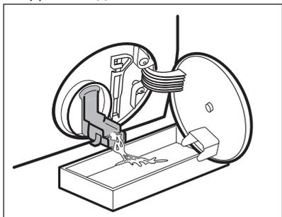
5. Когда контейнер наполнится водой, закройте сливную трубку и вылейте воду из контейнера.
