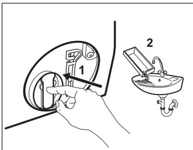
7. Закройте сливную трубку, а затем поверните фильтр против часовой стрелки, чтобы его извлечь.
