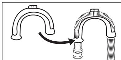
2. Путем установки шланга на край раковины - Привяжите направляющую к водопроводному вентилю или прикрепите ее к стене.
