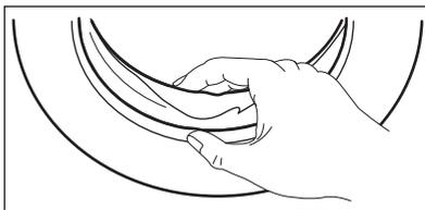
Регулярно проверяйте состояние уплотнителя и удаляйте все предметы с его внутренней стороны.
