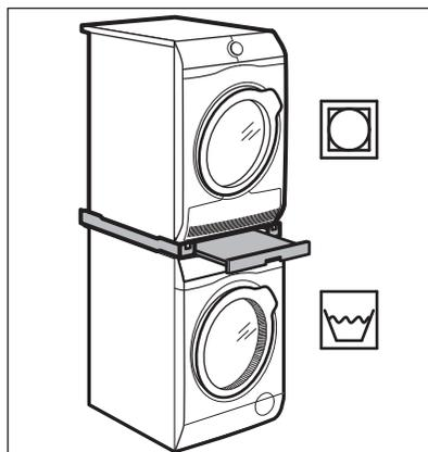
Сушильный барабан можно установить поверх стиральной машины **только при помощи подходящего комплекта для вертикальной сборки, который произведен и одобрен AEG.**
